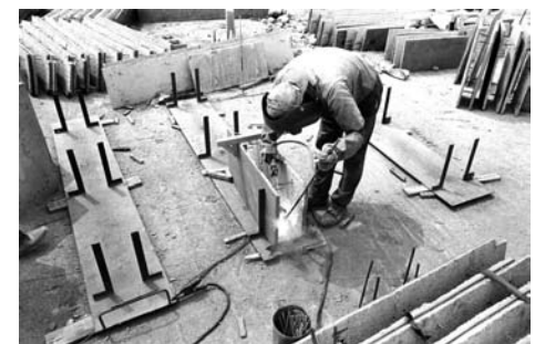
Steel jigs for accurately assembling wall components. Panel lowered into jig and distance pins welded together. Components are then rigid and can be lifted out. Plantillas de acero para ensamblar con precisión los componentes de la pared. El panel es instalado en la plantilla y los pernos espaciadores son soldados entre sí. Los componentes, ahora rígidos, pueden ser levantados.
